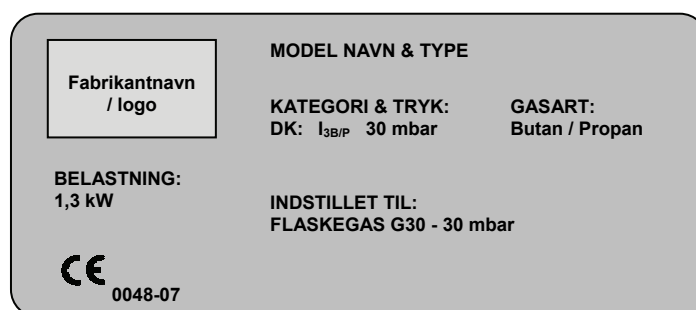
Figur 4-21. Eksempel – Mærkeskilt på lamper.
