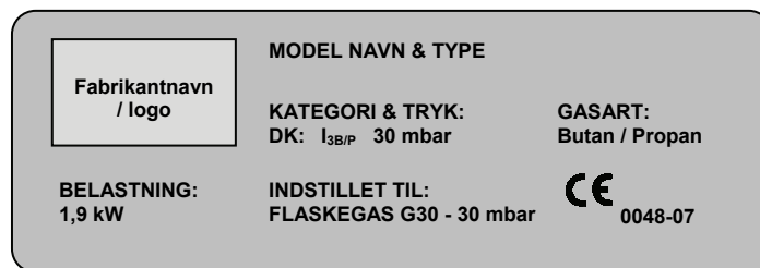
Figur 4-24. Eksempel – Mærkeskilt på køleskab.
