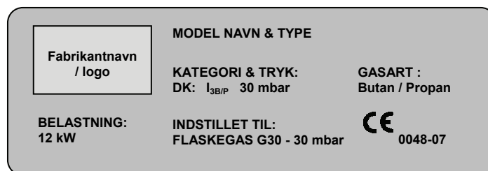
Figur 4-17. Eksempel – Mærkeskilt på vaskemaskine/tørretumbler.
