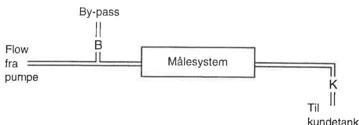
Der må ikke i forbindelse med målesystemet installeres nogen form for gasretur mellem kundetank og leveringstank.
