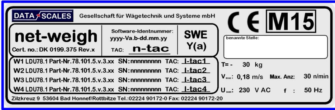
Abbildung 4 Typenschild net-weigh mit TAC-Zähler net-weigh: n-tac und den LDU TAC-Zählern: l-tac
