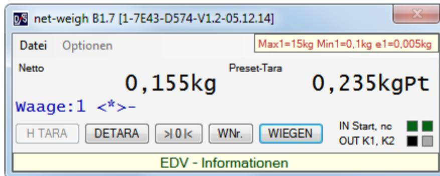
Abbildung 2 net-weigh mit Waage1, gesetzter Hand / Preset-Tara , mit allen Tastenfunktionen, mit EDV- und Kontaktstatus
