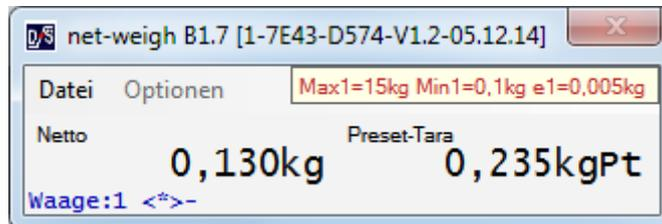
Abbildung 1 net-weigh mit Waage1, gesetzter Hand / Preset-Tara , ohne Tastenanzeige
