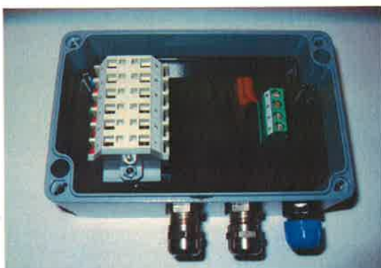
Pulser I/F enhed set med dækslet afmonteret
