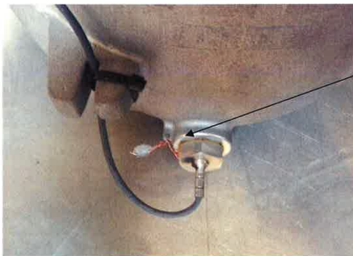
Eksempel på plombering til udstyr gennem hul ved flange.
