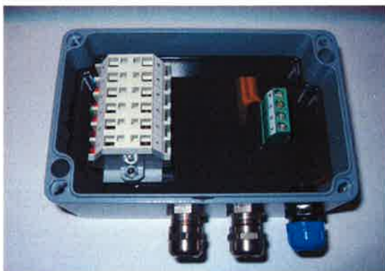
Pulser I/F enhed set med dækslet afmonteret
