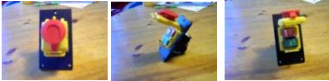
Figur 4: Flap stop anordning (taget fra det originale danske dokument MD ADCO 2005-19)
