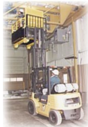
Arbejds kurv løftet med gaffeltruck
