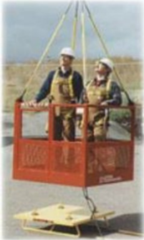
Krankurv løftet af en kran med stropper (løftetilbehør)
